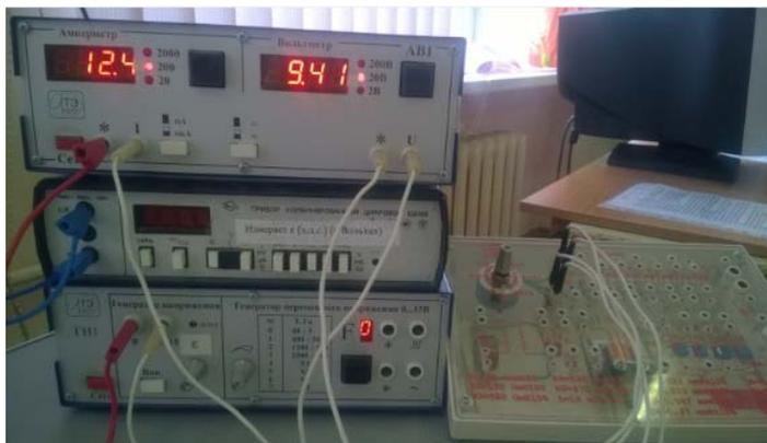
Рис. 10.2. Экспериментальная установка: измерительный блок АВ1, включающий цифровые вольтметр и амперметр, прибор комбинированный цифровой Щ4300, генератор напряжения ГН1, стенд с переменным сопротивлением
