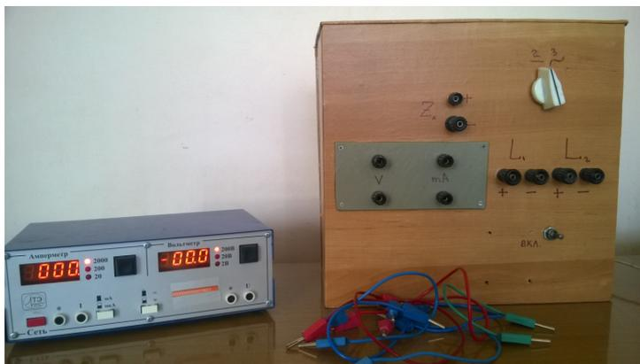
Рис. 16.3. Внешний вид установки: электронный амперметр и вольтметр в едином корпусе; лабораторный стенд
