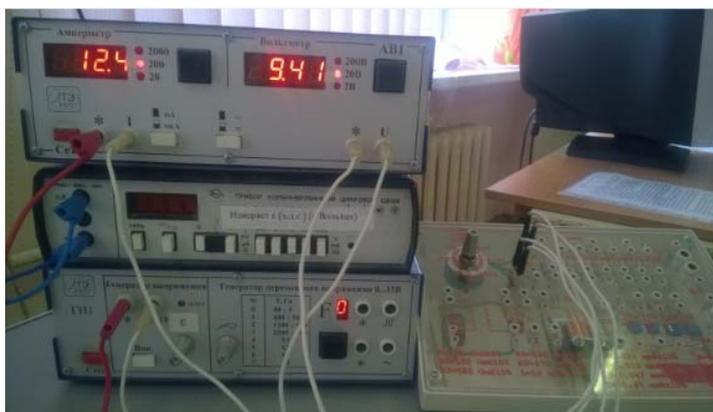
Рис. 9.2. Экспериментальная установка: измерительный блок АВ1, включающий цифровые вольтметр и амперметр, прибор комбинированный цифровой Щ4300, генератор напряжения ГН1, стенд с переменным сопротивлением
