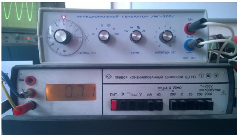
Рис. 17.3. Генератор сигналов и цифровой вольтметр
