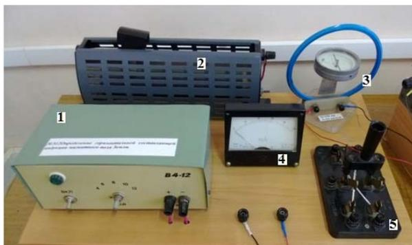
Рис. 12.2. Внешний вид установки: *1* – источник постоянного тока (выпрямитель В4-12); *2* – реостат со скользящим контактом; *3* – тангенс-гальванометр (тангенс-буссоль); *4* – миллиамперметр; *5* – переключатель
