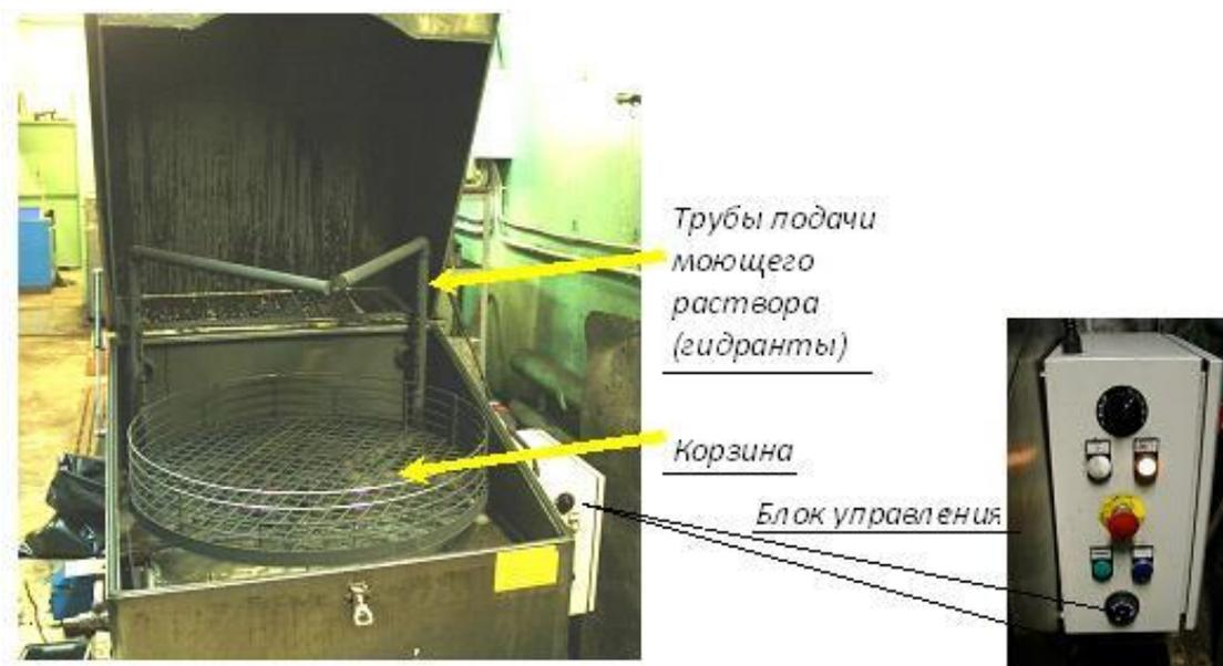
Рисунок 1 – Струйная моечная машина
