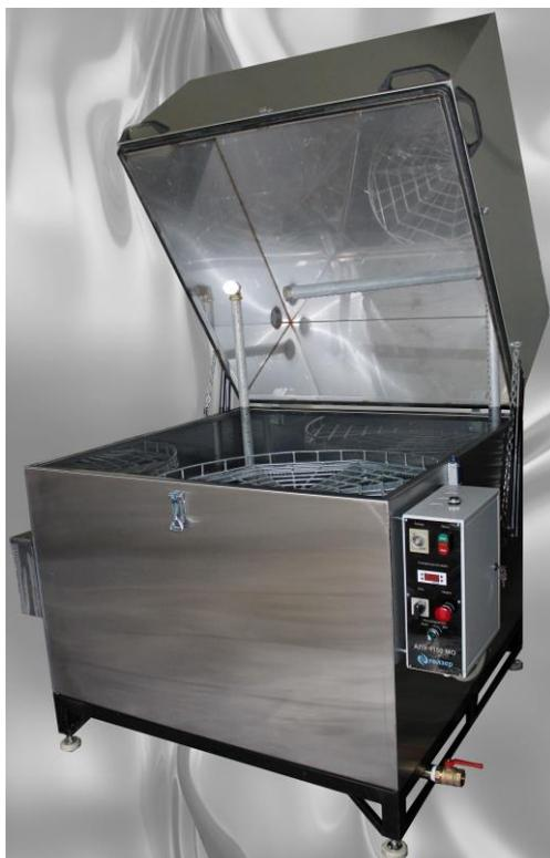
Рисунок 2 – Фотография оборудования моечная машина АПУ 1150
