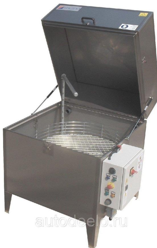
Рисунок 4 – Фотография оборудования моечная машина Magido ECO
