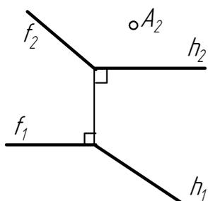
Построить недостающую проекцию точки  $A$ , отстоящей от плоскости  $\Sigma(f \cap h)$  на расстоянии 20 мм.
