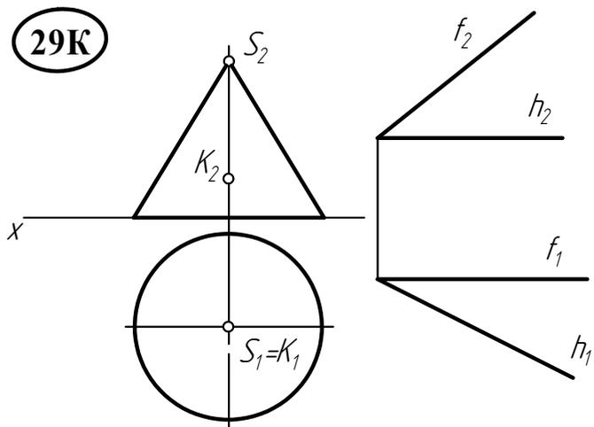
Через точку  $K$  провести нормаль к поверхности конуса, параллельную плоскости  $\Sigma(f \cap h)$ .
