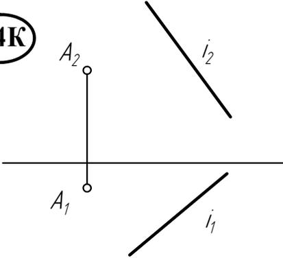
Повернуть точку  $A$  вокруг оси  $i$  до совмещения с фронтальной плоскостью проекций.
