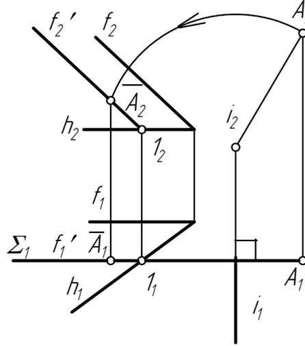
Ось перпендикулярна  $\Pi_2$ , следовательно, точка вращается во фронтальной плоскости уровня. Горизонтальная проекция траектории движения – прямая, перпендикулярная  $i_1(\Sigma_1)$ . Плоскость  $\Sigma(\Sigma_1)$  пересекается с исходной плоскостью  $\Gamma$  по фронталу  $f'$ . На  $\Pi_2$  проекция траектории движения точки – дуга окружности  $R|i_2 A_2|$ . При пересечении дуги с построенной проекцией фронтали получим искомую проекцию точки.
