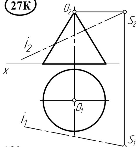
Построить очерк конической поверхности вращения с вершиной **S** и осью **i**, имеющей с заданным конусом одну общую точку. Принять во внимание, что вершины заданного и искомого конусов удалены от горизонтальной плоскости проекций на одинаковое расстояние.
