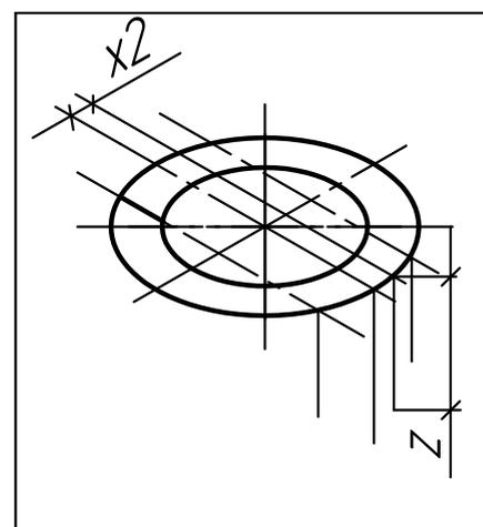
7. При построении стандартных аксонометрий разрешается эллипсы заменять овалами.
