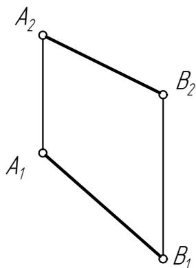
Достроить равносторонний треугольник **ABC**, наклонённый к плоскости проекций  $\Pi_4$  под углом **30°**.
