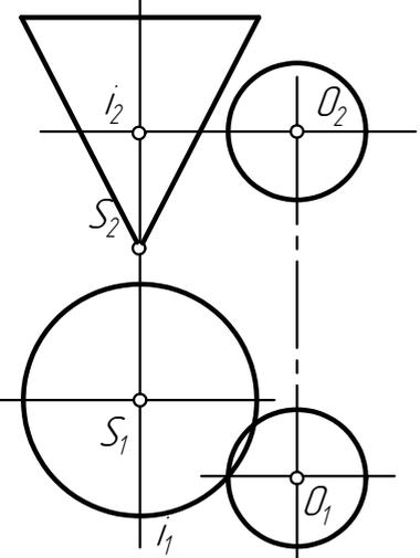
Дана сфера радиуса  $R$  с центром в точке  $O$  и конус вращения с вершиной  $S$ . Сфера вращается вокруг оси  $i$ , перпендикулярной фронтальной плоскости проекций, против часовой стрелки до касания с заданным конусом. Определить точку касания сферы и конуса.
