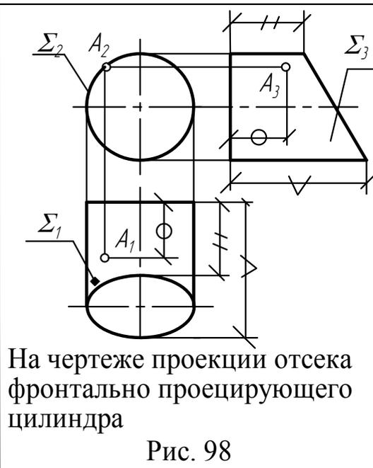
На чертеже проекции отсека фронтально проецирующего цилиндра
