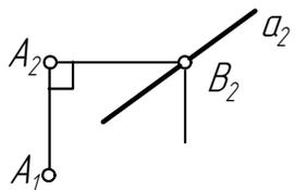
Найти горизонтальную проекцию прямой **a**, удалённой от точки **A** на расстояние **AB=40 мм**.
