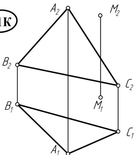
Постройте точку **M'**, симметричную точке **M** относительно плоскости общего положения  $\Gamma(ABC)$ .
