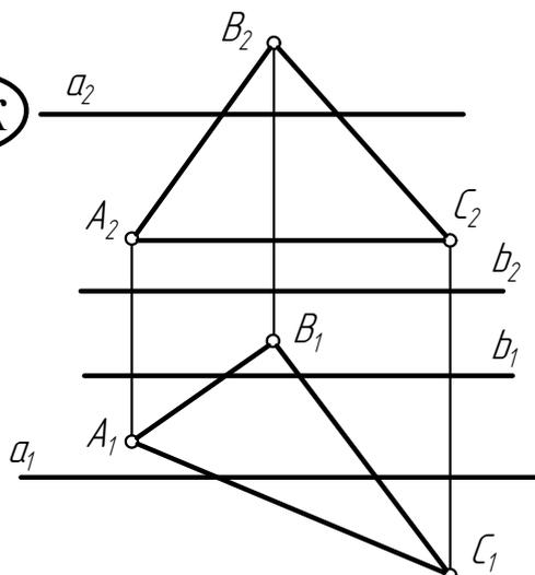
Шар радиусом **R=20 мм** катится (под собственным весом) по плоскости  $\Sigma(ABC)$  и проходит через точку **B**. Найти центр шара в момент его касания плоскости  $\Gamma(a \parallel b)$ .
