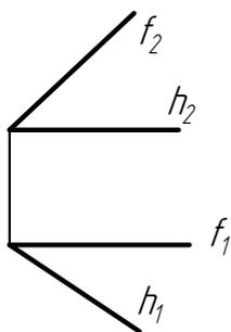
Построить всё множество точек, удалённых от плоскости  $\Sigma(f \cap h)$  на 30 мм.
