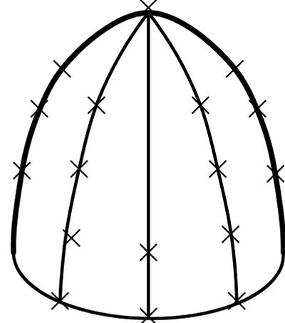
Поверхность разбита меридианами на равные доли, которые заменяют цилиндрическими поверхностями.
