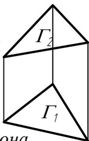
Для определения угла наклона к  $\Pi_2$  достаточно одной замены.
