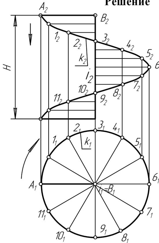
Точка  $A$  описывает правую винтовую линию  $k$  шага  $H$  с осью  $i$ . Шаг винтовой линии – это расстояние, которое проходит точка за один оборот. Соответствующий одному шагу отрезок винтовой линии называют витком. Винтовую линию называют правой, если точка, опускаясь, вращается по часовой стрелке, и левой, если против часовой стрелки.
