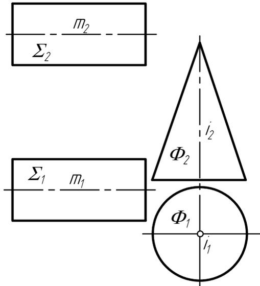
Даны конус вращения  $\Phi$  с осью  $i \perp \Pi_1$  и цилиндр вращения  $\Sigma$  с осью  $m \perp \Pi_2$ . Построить такую плоскость  $\Gamma$ , чтобы эллипсы  $k$  и  $k'$ , полученные при пересечении с ней, были равны. Построить эти эллипсы.
