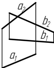
Для нахождения искомого расстояния необходимо одну из прямых преобразовать в проецирующую. Выполняем две замены. Первую плоскость  $\Pi_4$  вводим параллельно одной из прямых ( $a$ ), соответственно на чертеже проводим ось параллельно одной из проекций выбранной прямой.
