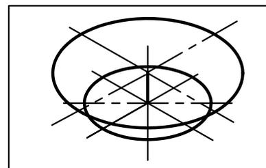
6. Построение паза выполняем, строго соблюдая параллельность его элементов основным аксонометрическим осям. Точки линии пересечения полуцилиндрического участка паза с наружным и внутренним цилиндрами строим при помощи образующих этих цилиндров. Сначала на заданном расстоянии по оси **OX** фиксируем точку, затем через нее проводим прямую, параллельную оси **OY**, до пересечения с эллипсом, от точки пересечения откладываем размер образующей по оси **OZ**.
