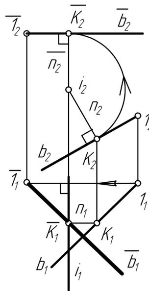
Прямая, перпендикулярная фронтально проецирующей оси, параллельна  $\Pi_2$ . Следовательно, на  $\Pi_2$  можем задать проекцию нормали к фронтальной проекции прямой. Повернув нормаль в горизонтально проецирующее положение, получим горизонтальное расположение прямой. На  $\Pi_1$  проекции точек движутся по прямым, перпендикулярным проекции оси.
