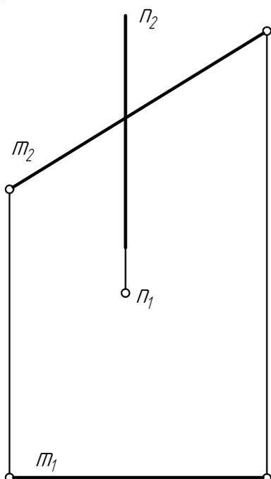
Даны проекции определителя гиперболического параболоида (косой плоскости)  $\Sigma[m, n, \Gamma || \Pi_1]$ . Построить прямоугольную изометрию заданной поверхности, предварительно выполнив построение её проекций.
