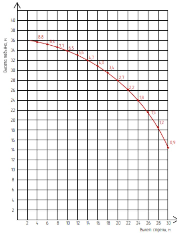
Рисунок В.1 – график грузоподъемности крана SANY SRC500T.
