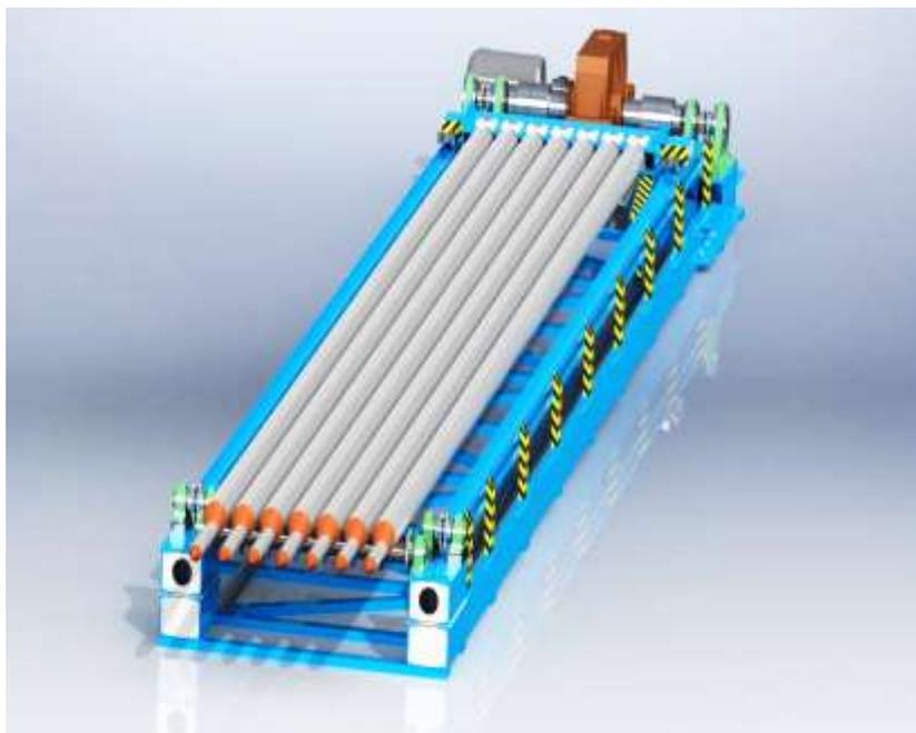
Рисунок 2 – Формовочная машина СМЖ-227Б
