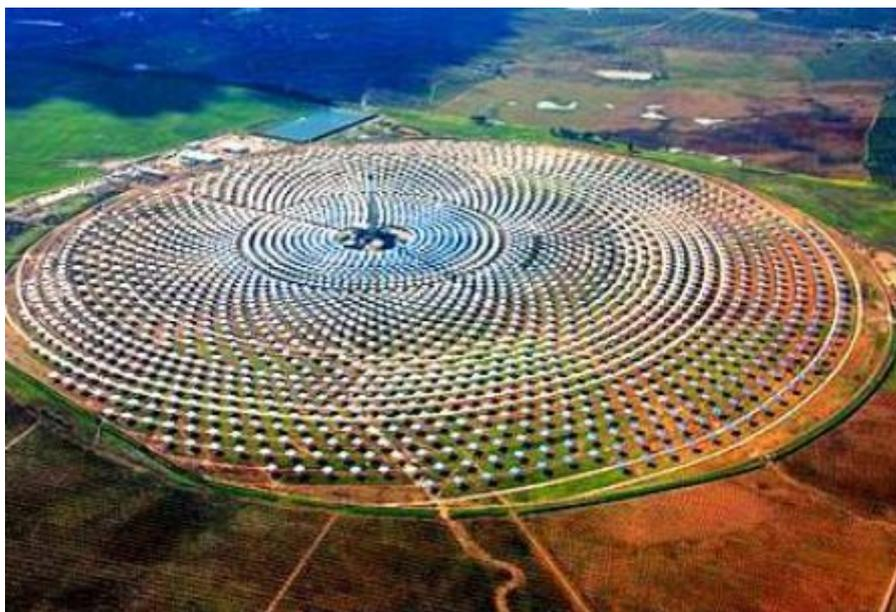
Рисунок 11 – Башенная СЭС
