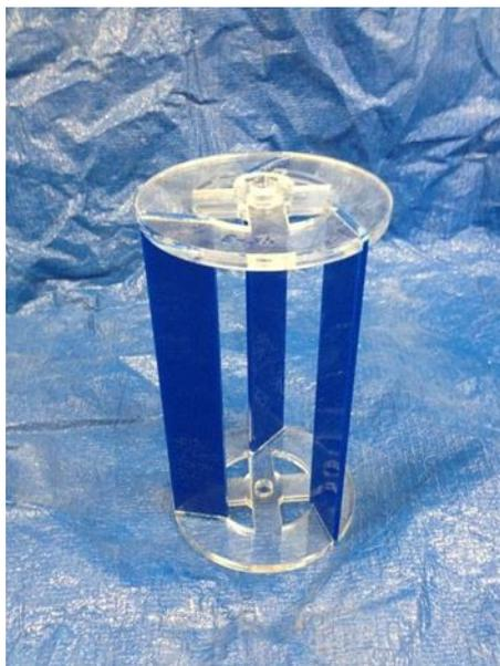
Рисунок 9 - Ветряная турбина с вертикальной осью
