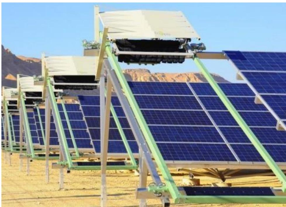
Рисунок 20 – Система очистки Escoria
