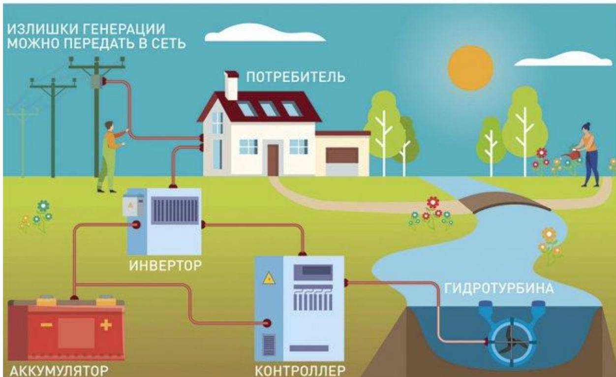
Рисунок 38 – Схема подключения микро ГЭС
