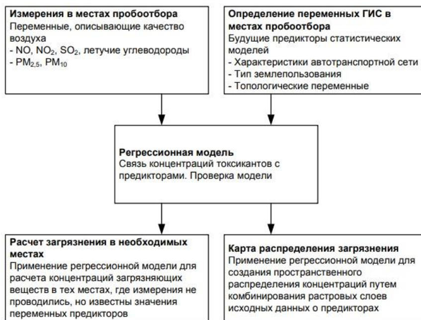
Рисунок 4 – Алгоритм моделирования методом Land Use Regression
