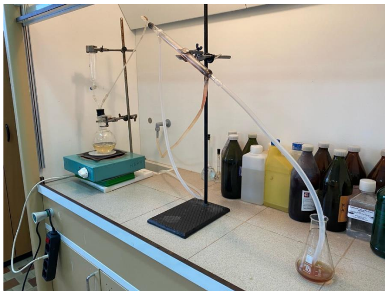
Рисунок 2- Установка для отгонки аммиака собранная в лабораторных
