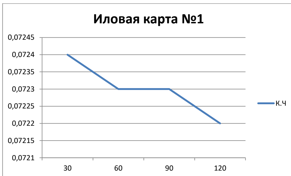
Рисунок 7 – График зависимости кислотного числа от времени (с иловой карты №1)
