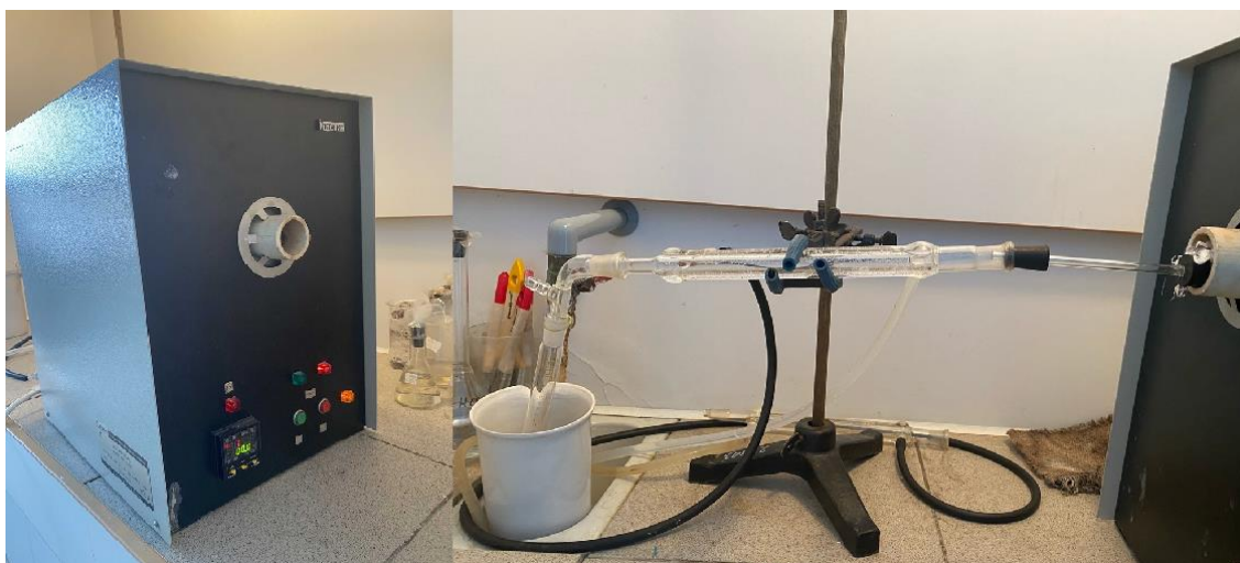
Рисунок 4 – Физическая модель установки пиролиза в лабораторных условиях Исходные данные для процесса пиролиза представлены в таблице 10.
