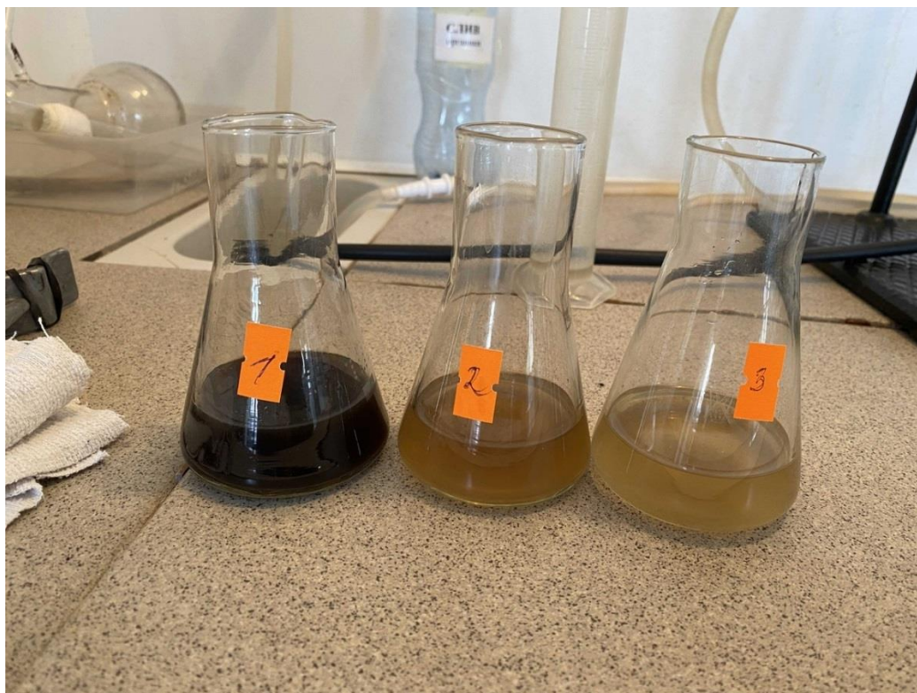
Рисунок 6- Продукты после отгонки водяным паром
