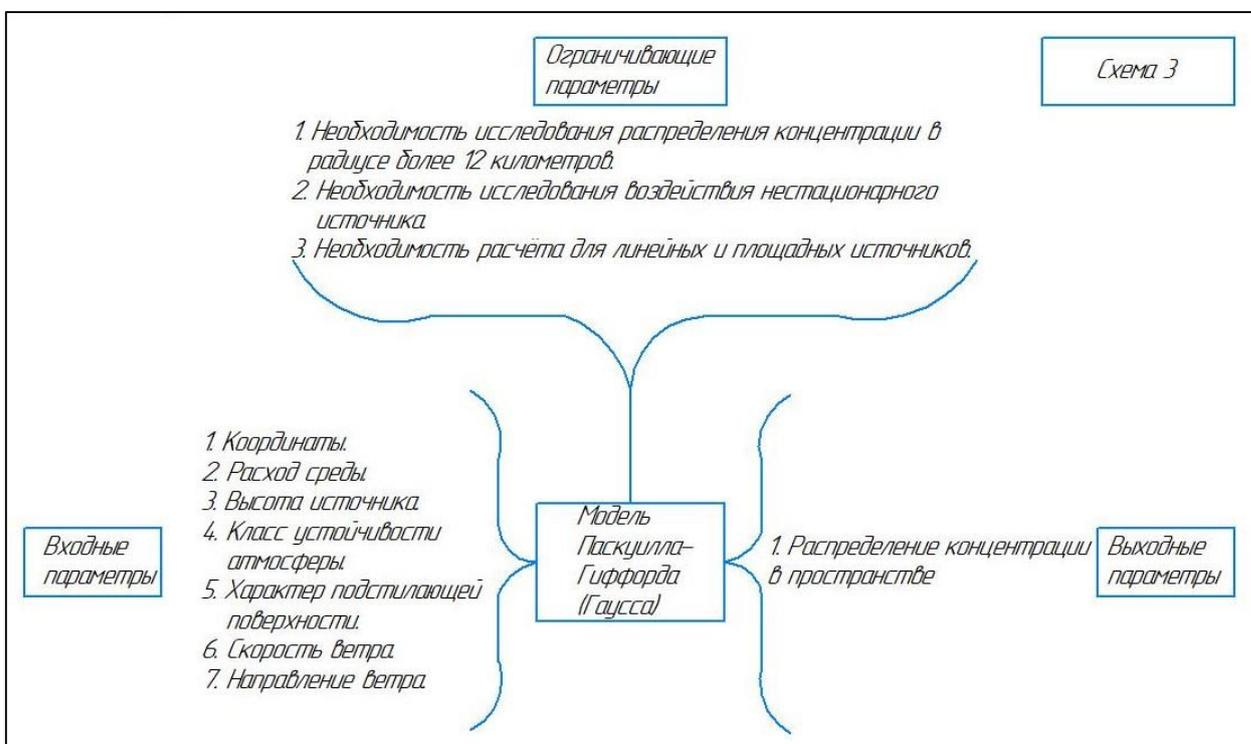
Рисунок 7 – Модель Паскуилла – Гиффорда (Схема 3)
