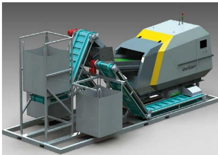
Рисунок 15 – Сепаратор UniSort Flake американской компании Steinert
