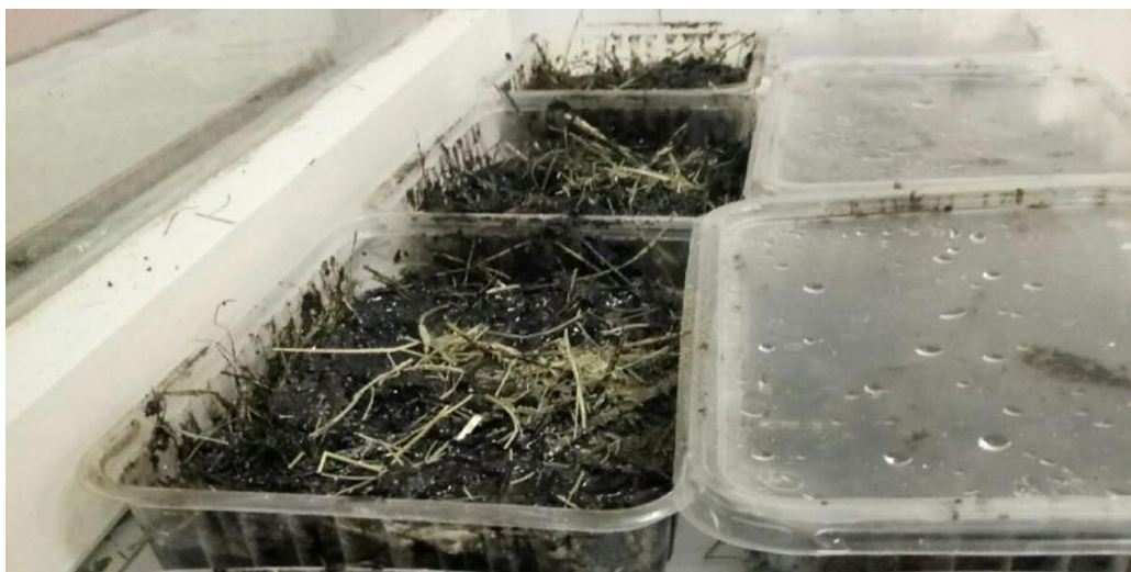
Рисунок 22 – Замешанные образцы исследуемых отходов нефтешлама
