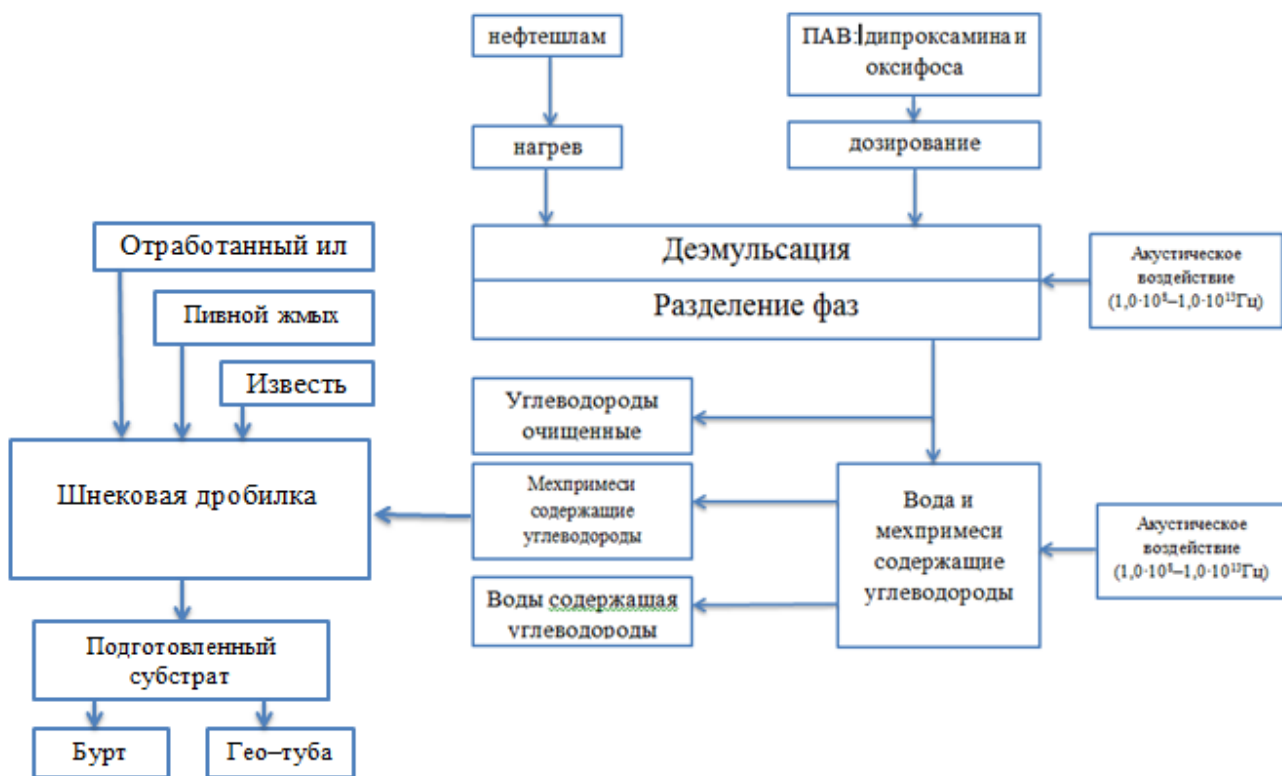
Рисунок 12 – Блок-схема предлагаемой физико – химической модели обезвреживания отходов нефтешлама
