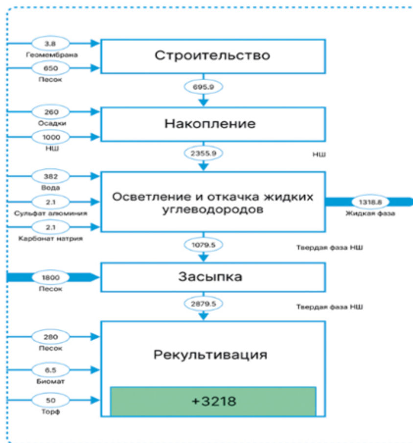
Рисунок 2 – Этапы метода захоронения отходов нефтешламов обезвоживание биологическими методом
