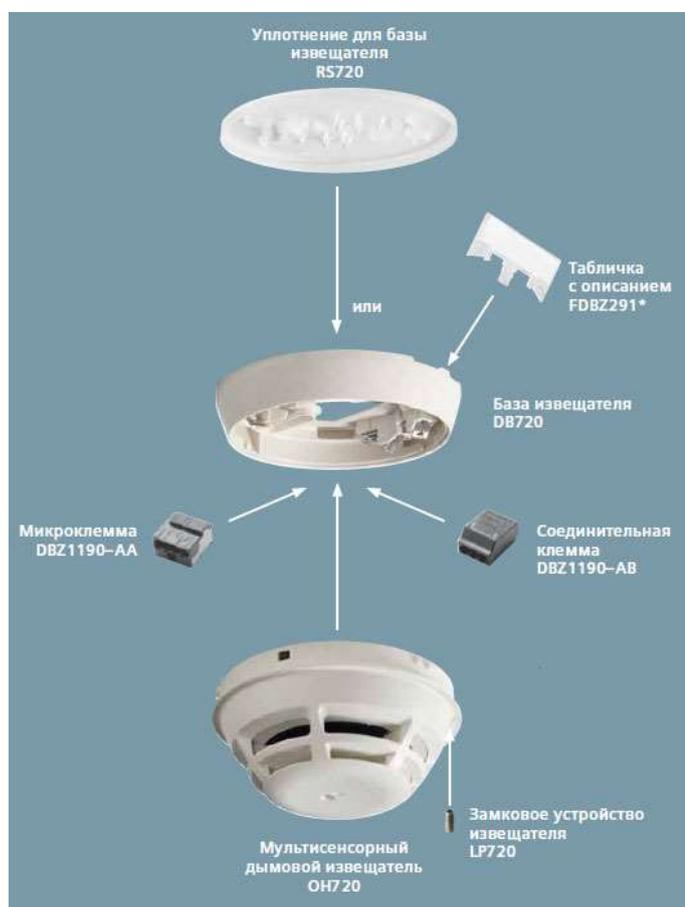
Рисунок 1 – Схема извещателя Siemens ASAtеchnology
