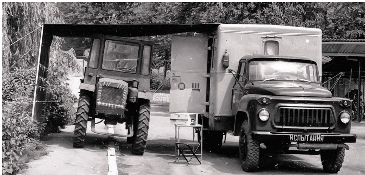
Рисунок 3 – Передвижная ремонтная мастерская МПР-9924
