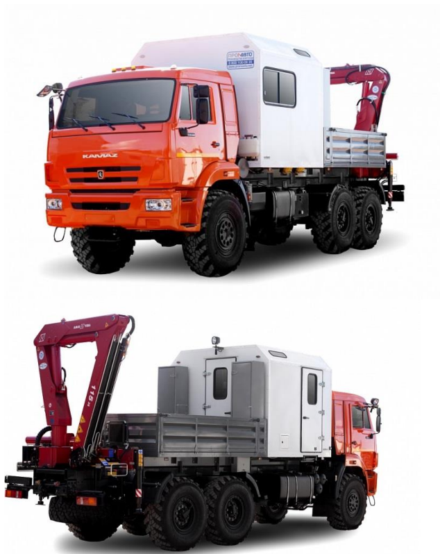
Рисунок 7 – Передвижная техническая полевая помощь с КМУ «ИНман – ИМ 25»
