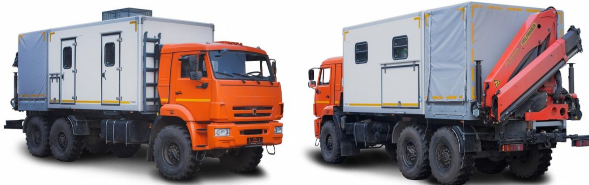
Рисунок 6 – Передвижная техническая помощь с КМУ на шасси КамАЗ-43118
