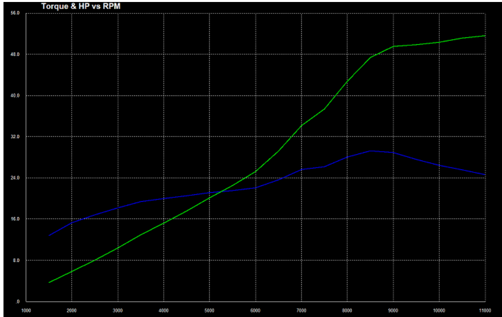
Рисунок 16 – ВСХ двигателя с симуляции в программе Engine Analyzer Pro V3.9
