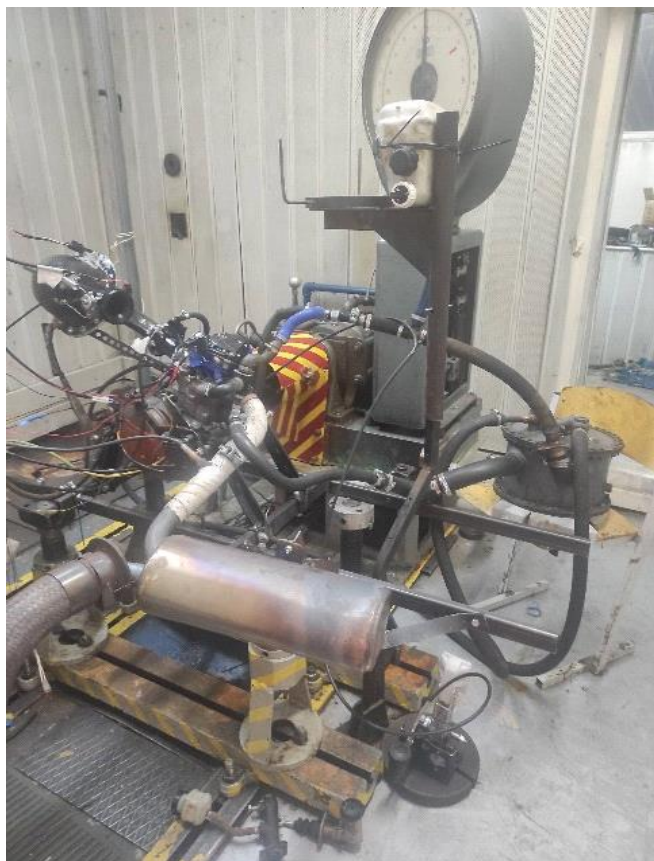
Рисунок 37 – Двигатель KTM 450 EXC-F установленный на динамометрический стенд
