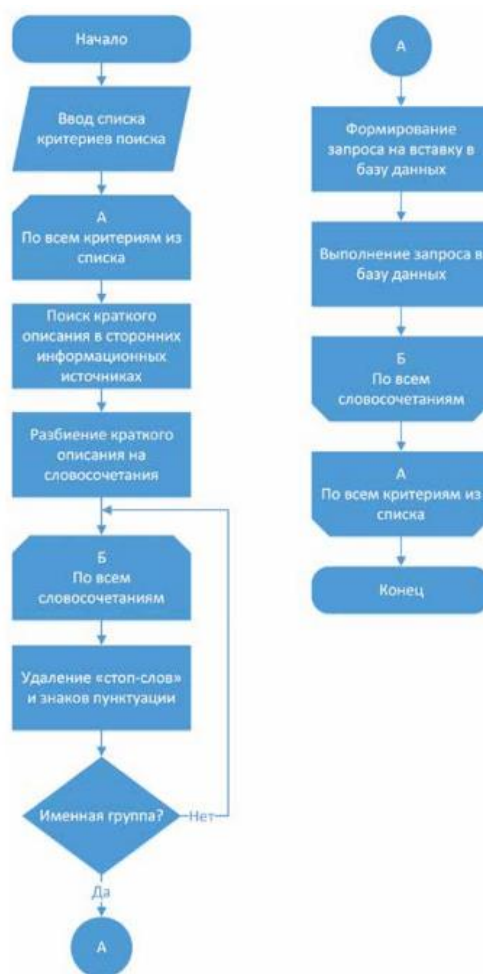
Рисунок 10 – Блок-схема алгоритма токенизации
