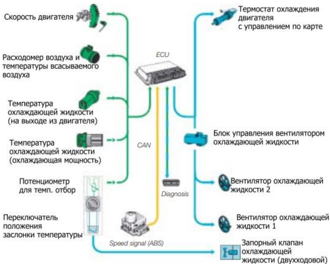
Рисунок 39 – Схема электронного управления охлаждением двигателя
