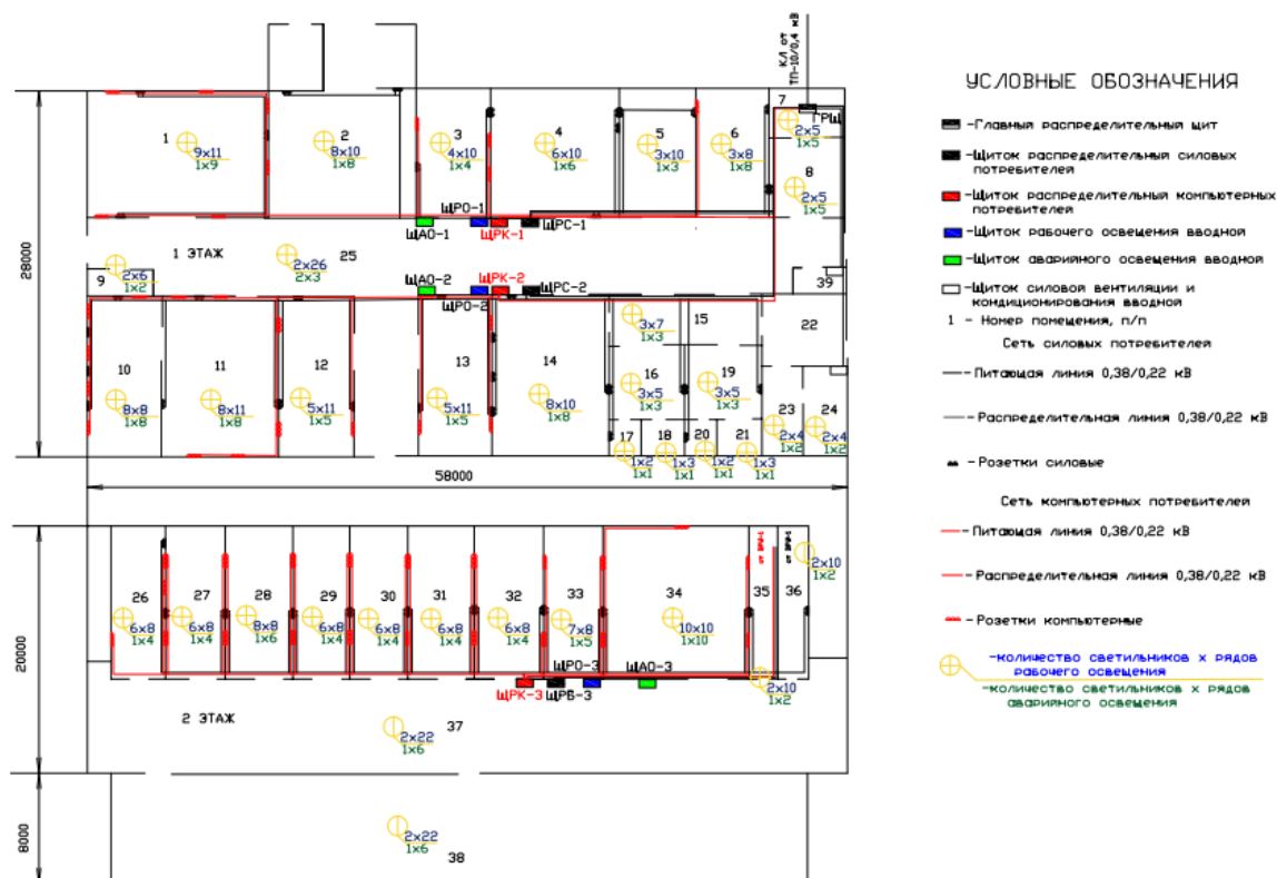
Рисунок 9 – Монтажная электрическая схема внутреннего электроснабжения школы
