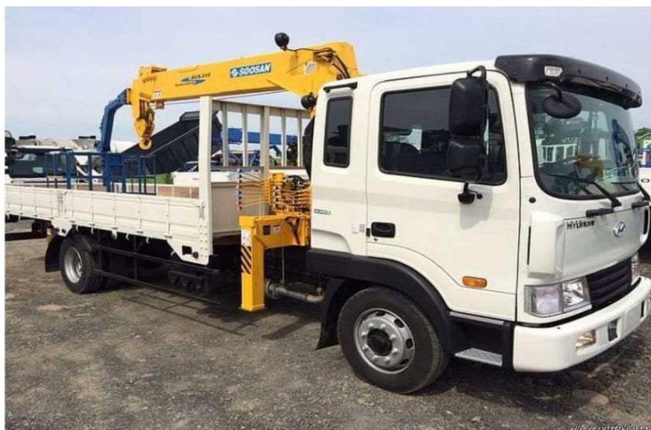
Рисунок 3 – Манипулятор, НО-120 (стрела 10.7 м) для перемещения и доставки поддонов на отметку 0,000
