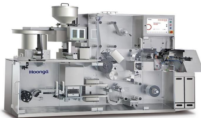
Рисунок 7 – Картонажная машина для упаковки таблеток в блистерах в картонные коробки
