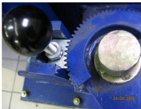
Рисунок 4.4 – Система автоматическо-механической фиксации
