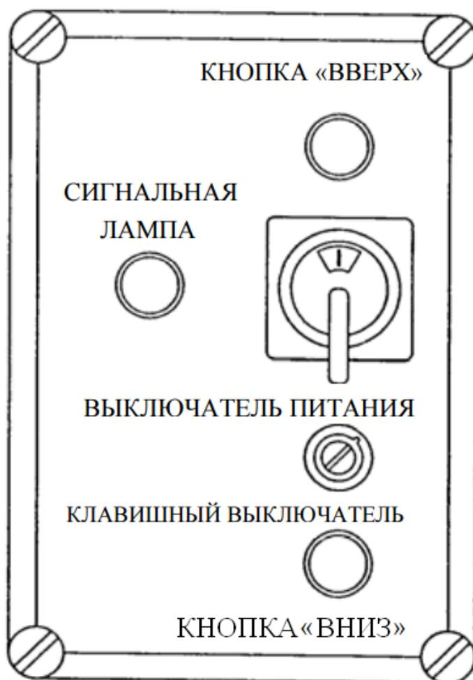
Рисунок 4.12 – Панель управления подъемником
