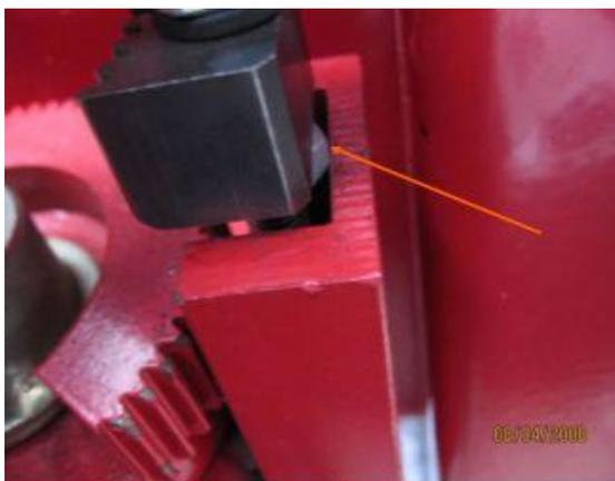
Рисунок 4.7 – Гайка упирается в направляющую, смещая положение блока зубцов
