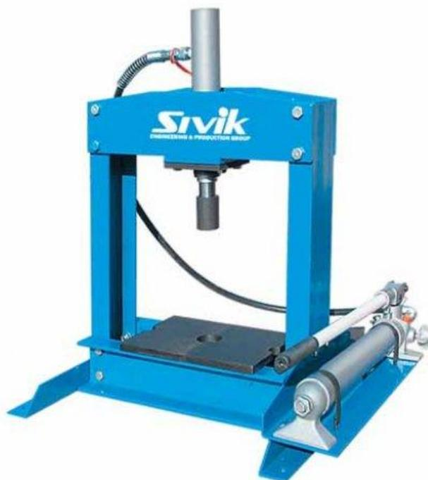
Рисунок 1.4 – Пресс гидравлический (настольный) КС-126
