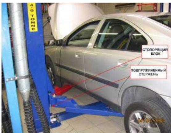
Рисунок 4.3 – Вид подъемника в действии с зафиксированными лапами
