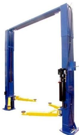
Рисунок 4.1 – Стационарный двухстоечный автомобильный подъемник ПГВ 2-4.0.
