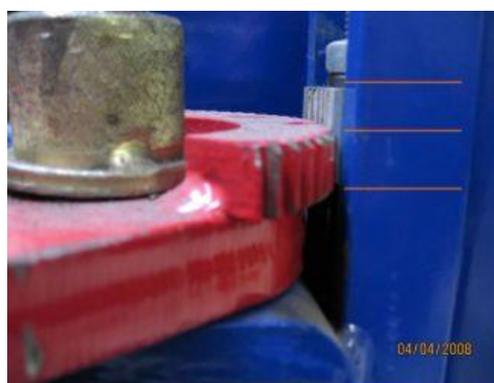
Рисунок 4.5 – Несоответствие относительных высот (перекос) зубцов может привести к уменьшению удерживающей способности
