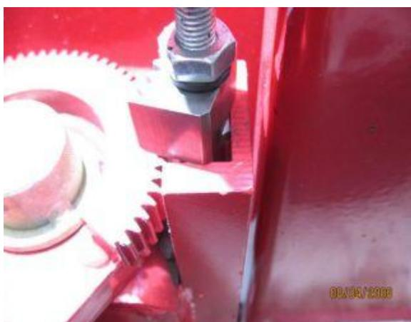
Рисунок 4.8 – Блок зацеплен за направляющую, не работает фиксация
