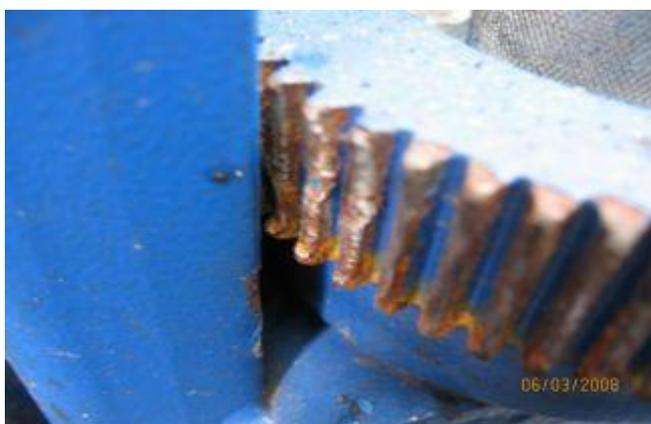
Рисунок 4.9 – Износ зубцов из-за смещенного блока
