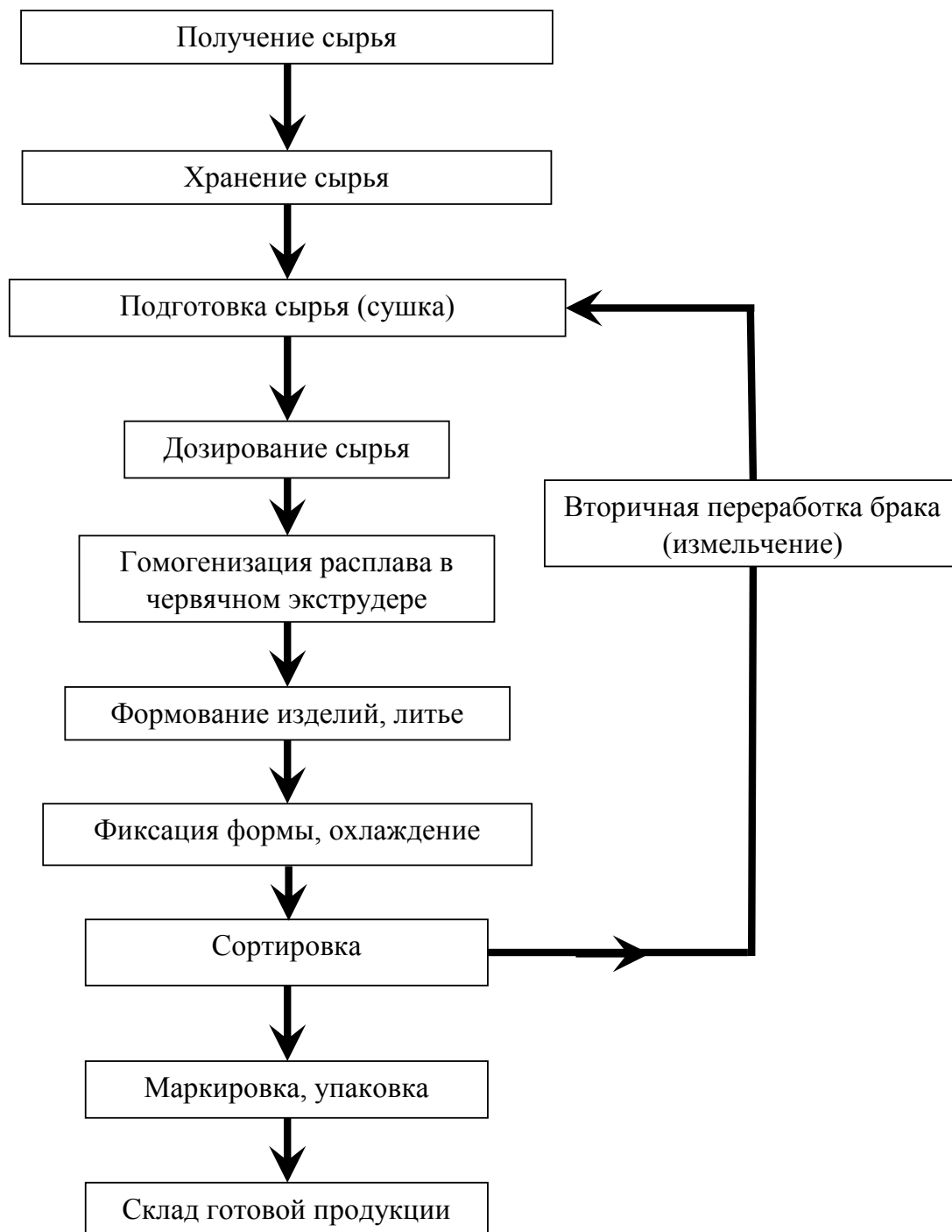
Рисунок 2 – Блок-схема технологического процесса производства пластиковых аксессуаров для систем вентиляции и кондиционирования методом литья под давлением
