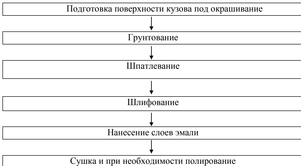
Рисунок 2.2 – Технологический процесс капитального ремонта лако-красочного покрытия автомобиля
