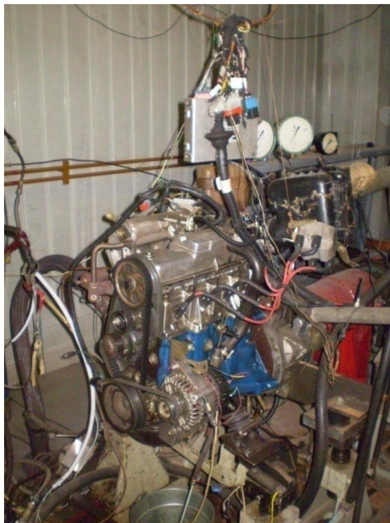
Рисунок 18 – Двигатель ВАЗ-2111 с распределенным впрыском топлива, подготовленный к проведению исследований
