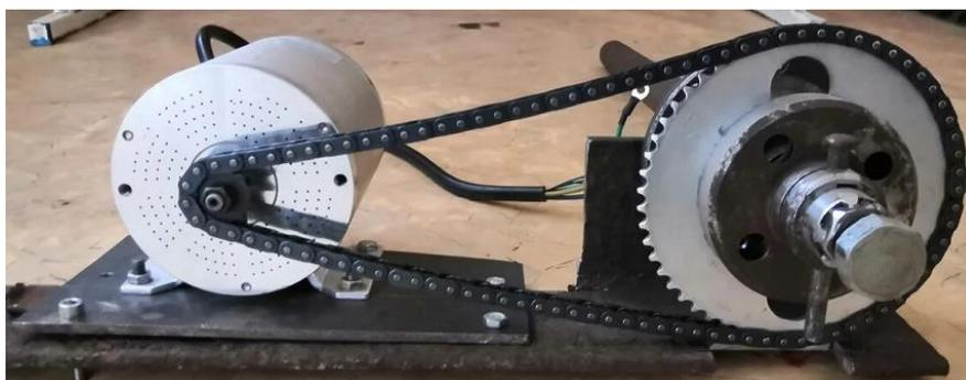
Рисунок 15 – Цепная передача
