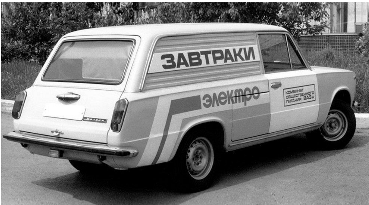
Рисунок 5 – Электромобиль на базе автомобиля ВАЗ-2102
