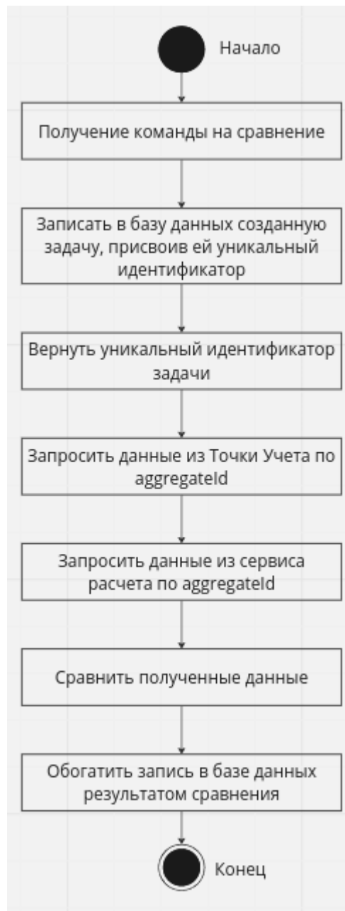
Рисунок 15 - Алгоритмы обработки команды на сравнение
