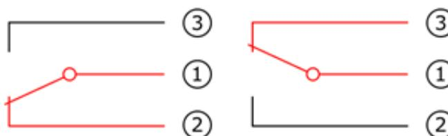
Рисунок 8 – Принцип работы переключателя а - не нажата, б - нажат
