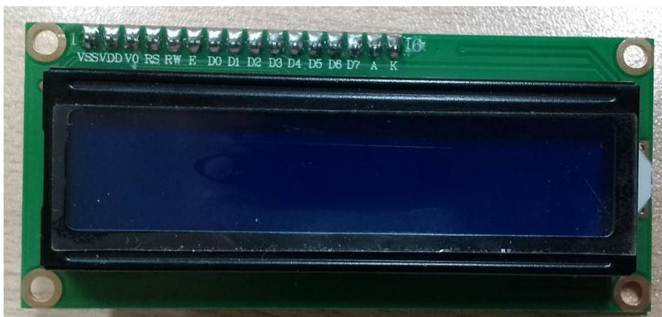
Рисунок 16 – LCD дисплей
