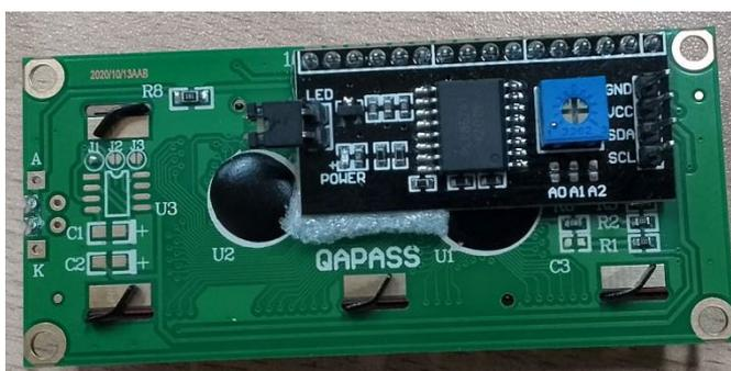
Рисунок 17 – Модуль I2C
