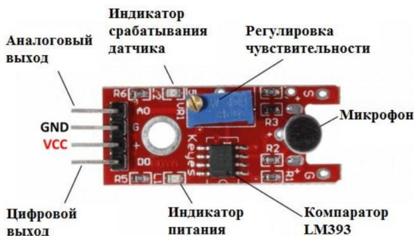
Рисунок 13 – Лицевая сторона датчика звука KY-037
