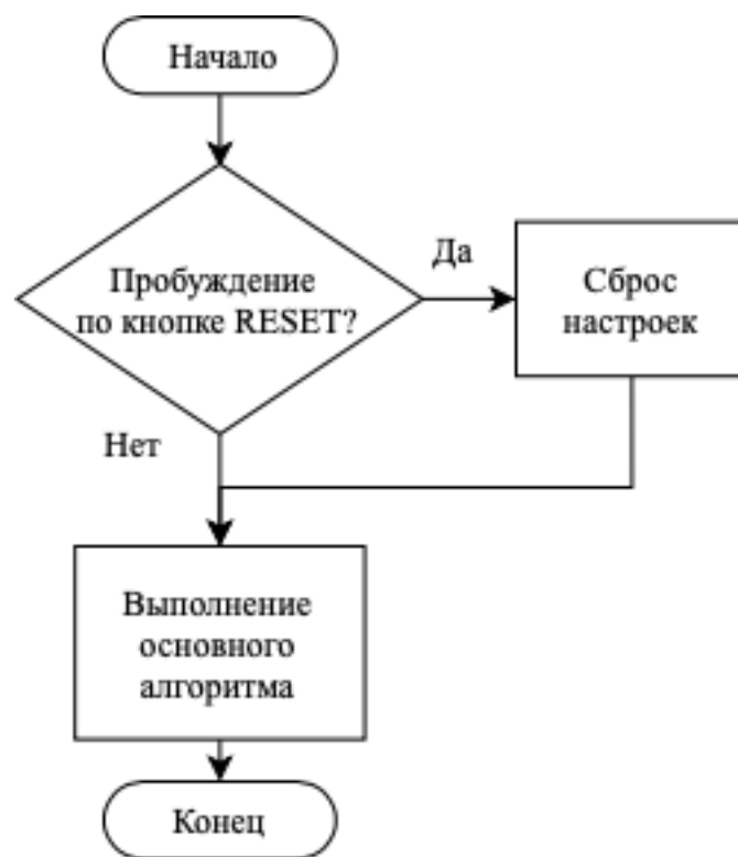
Рисунок 24 – Блок-схема алгоритма сброса настроек по нажатию на кнопку
