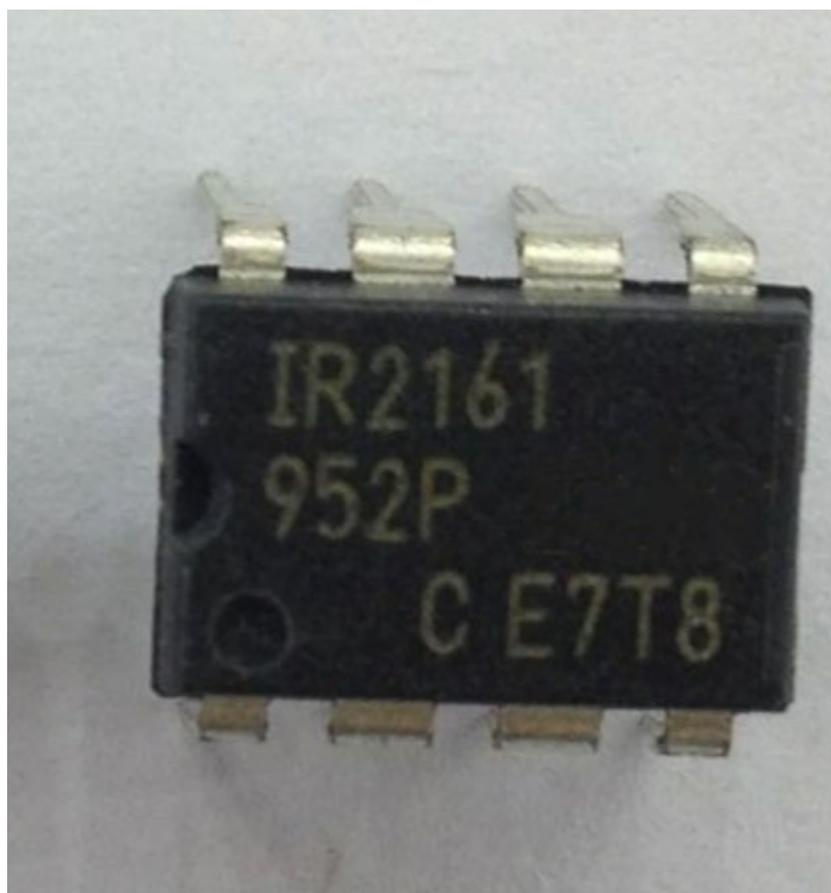
Рисунок 11 – Контроллер IR2161
