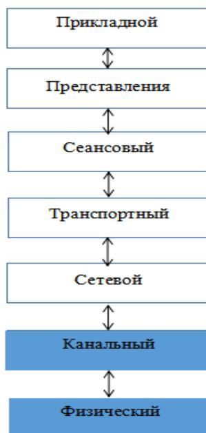
Рисунок 8 — Wi-Fi по модели OSI
