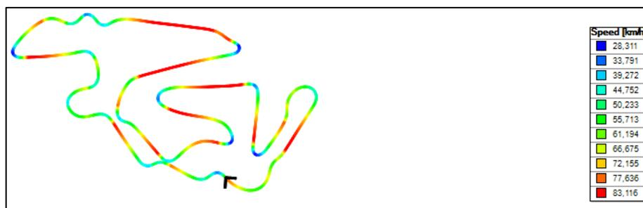
Рисунок 43 – Скорость движения болида на трассе FSAE Endurance Germany 2012 на шинах Hoosier 10” с давлением 1,2 атмосфер
