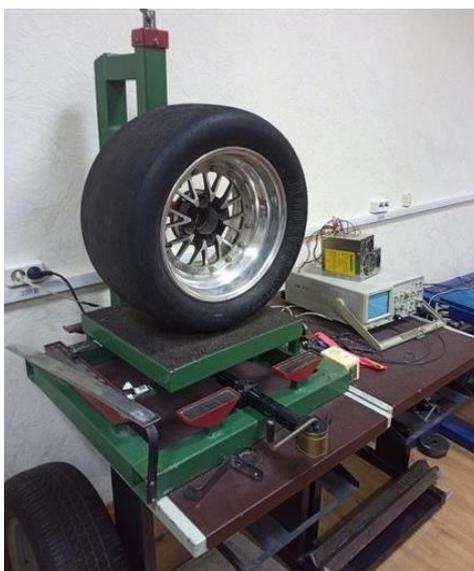
Рисунок 21 – Испытательный стенд для расчета коэффициентов сцепления
