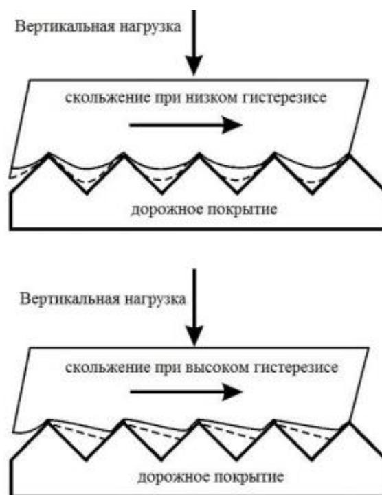
Рисунок 20 – Гистерезис при скольжении шины
