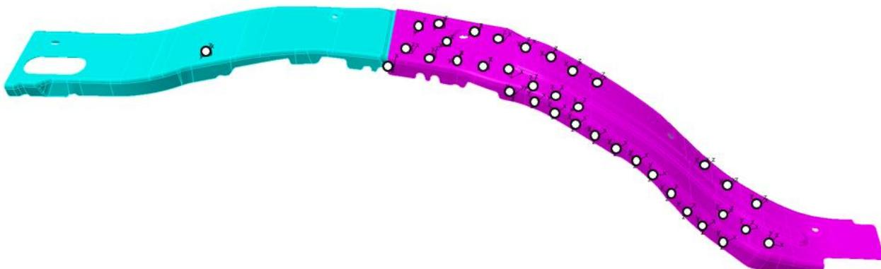
Рисунок 4 – Распределение вспомогательных варочных точек
