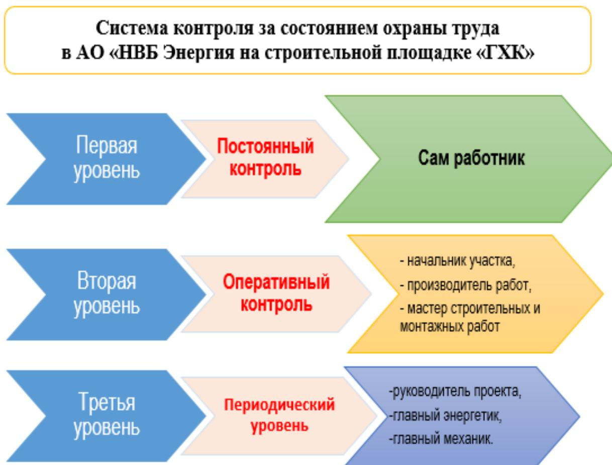
Рисунок 4 – Система контроля за состоянием охраны труда в АО «НВБ Энергия на строительной площадке «ГХК»
