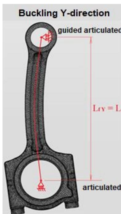
Рисунок 38 – Изгиб шатуна в Y-направлении
