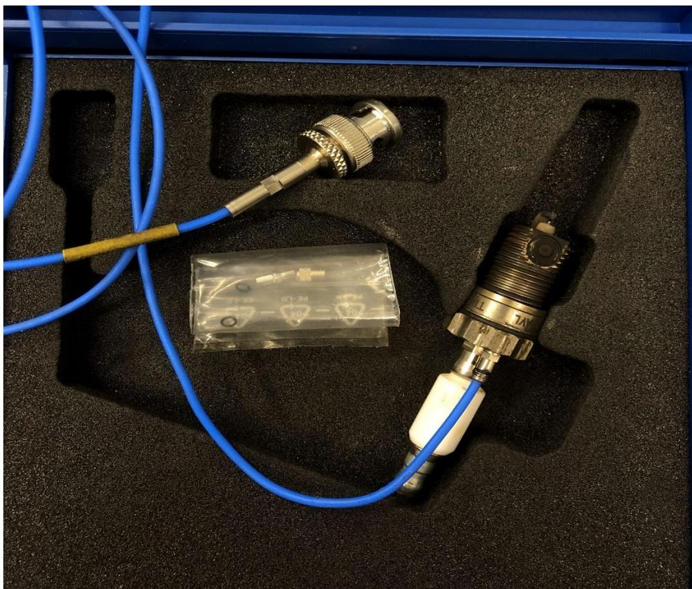
Рисунок 19 – Свеча зажигания с датчиком
