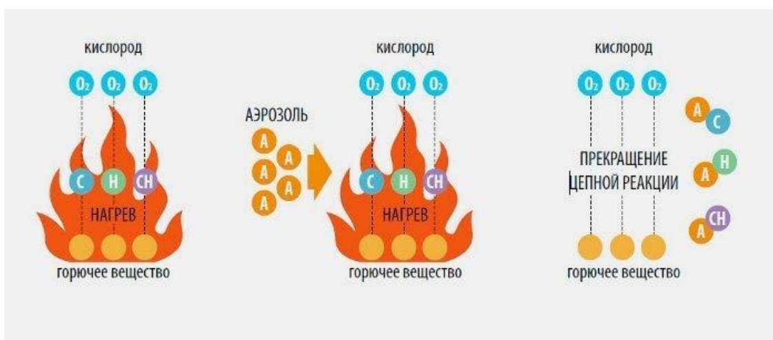
Рисунок 8 – Действие аэрозольного пожаротушения
