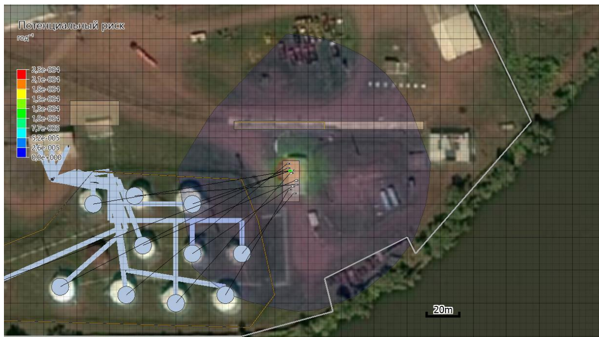
Рисунок 2 – Поле потенциального риска при разрушении трубопроводов
