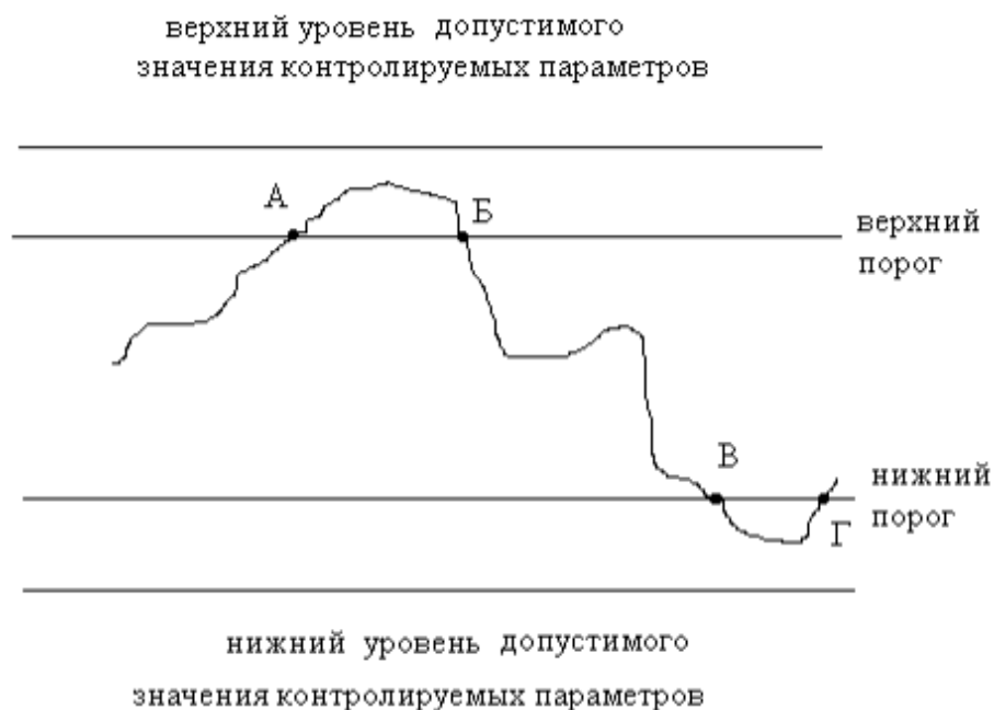
Рисунок 11 – Пояснение работы системы с заданными пороговыми уровнями
