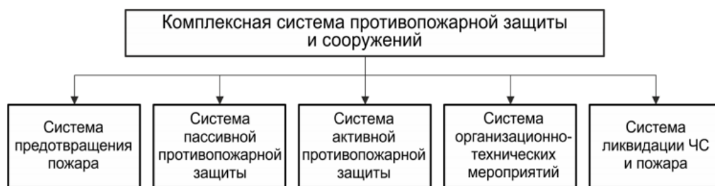
Рисунок 15 – Комплексная система противопожарной защиты
