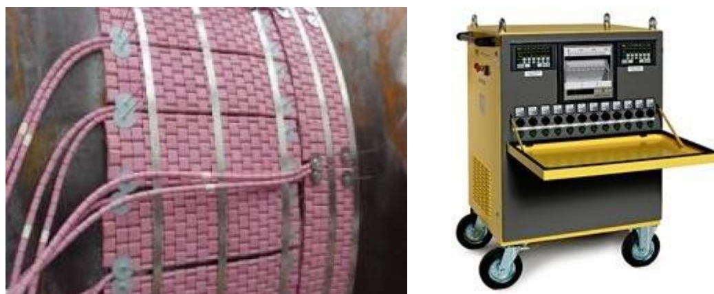
Рисунок 20 - Оборудование серии «Standart Europa»: нагревательные элементы (а) и передвижная термостанция «WeldoTherm» (б)
