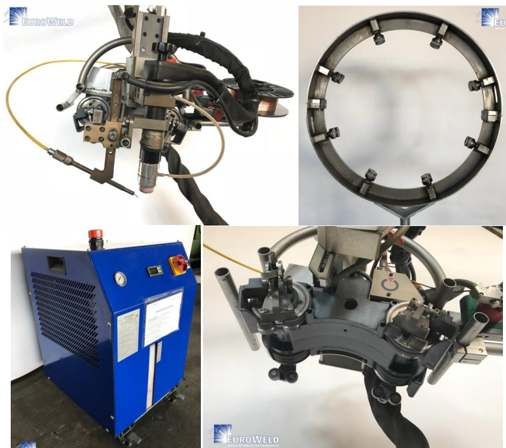
Рисунок 19 – Комплект оборудования AutoTIG 600PC для сварки стыков трубопроводов
