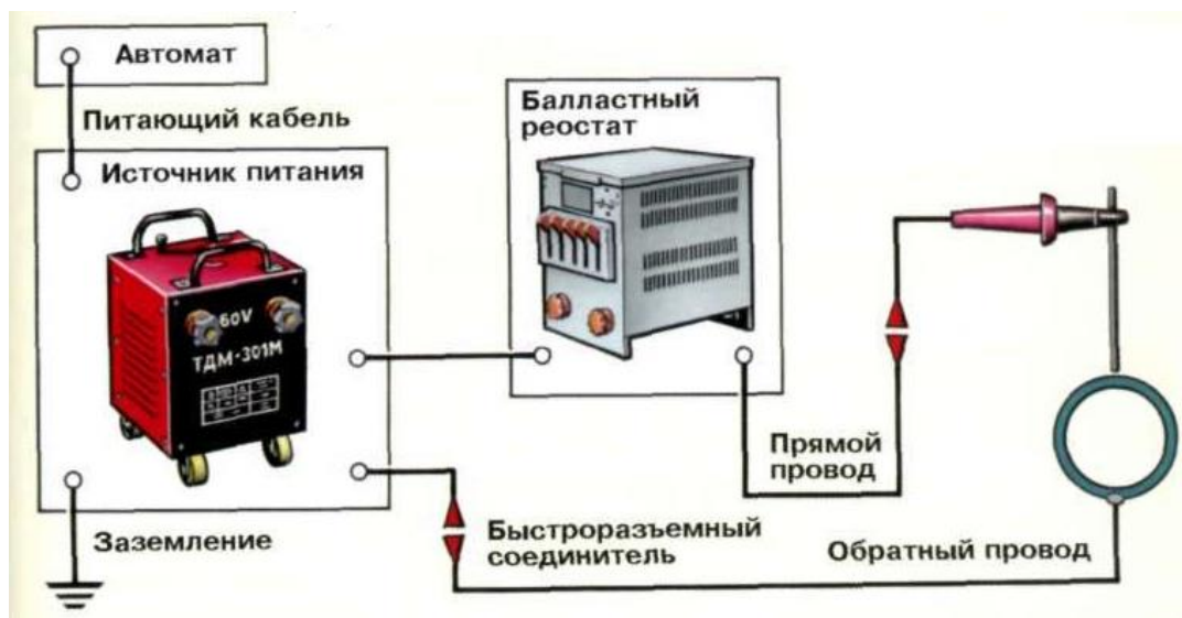
Рисунок 7 – Схема выполнения ручной дуговой наплавки
