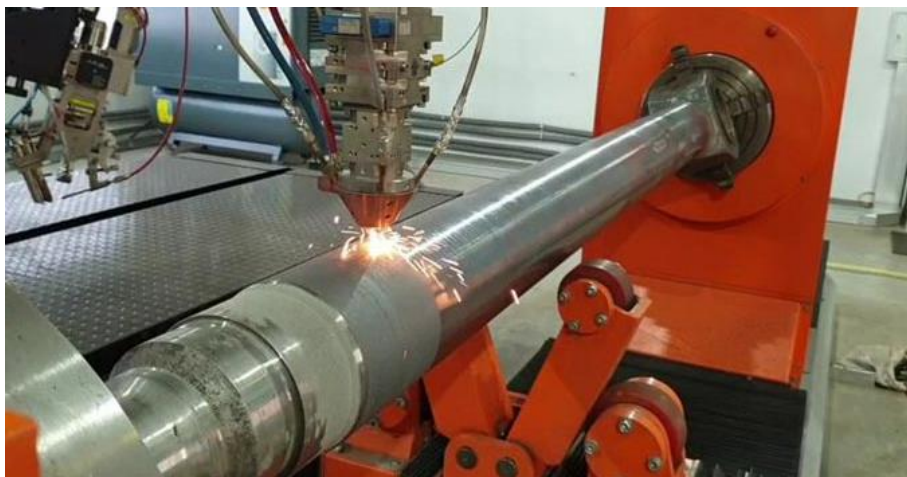
Рисунок 10 – Применение лазерной наплавки для восстановления валов
