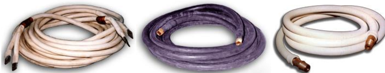
Рисунок 15 – Набор кабелей для проведения индукционного нагрева стыка труб: малоиндукционный токоподводящий кабель, водоохлаждаемый индукционный токоподвод и водоохлаждаемый гибкий индукционный кабель
