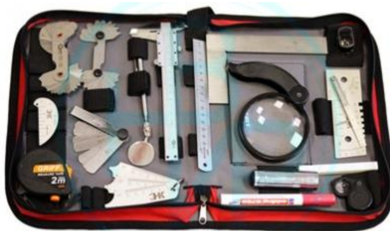
Рисунок 6 – Набор для проведения визуального контроля
