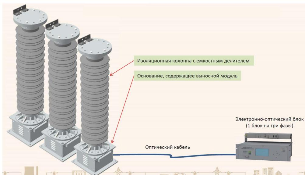
Рисунок 15 – Структурная схема оптического ТН
