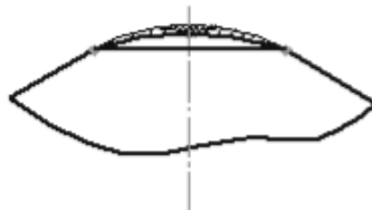
Рисунок 3.7 - Схема съема припуска при переточке инструмента на больший радиус
