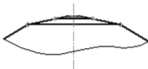
Рисунок 3.6 - Схема съема припуска при переточке изношенного инструмента на тот же радиус
