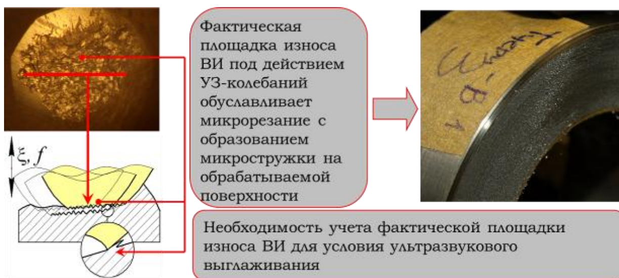
Рисунок 2.9 – Схема, поясняющая особенности износа инструмента при ультразвуковом выглаживании
