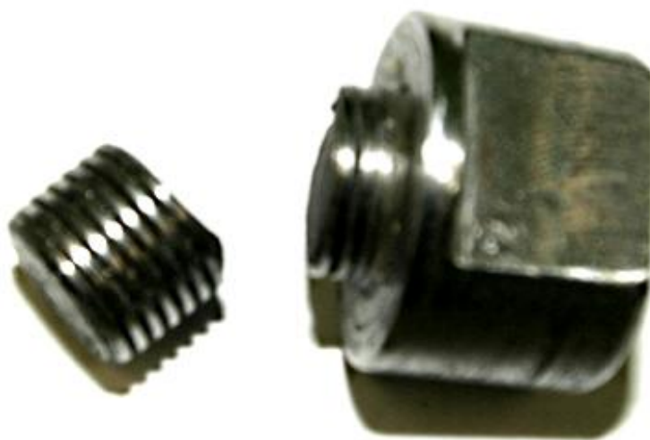
Рисунок 2.7 - Разрушения резьбового участка инструмента
