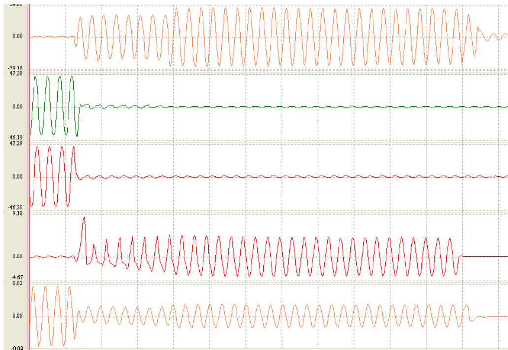
Рисунок 12 – Осциллограмма напряжений фаз А, В, С на 1 секции ГПП 35 кВ, ток двухфазного замыкания одного из присоединений
