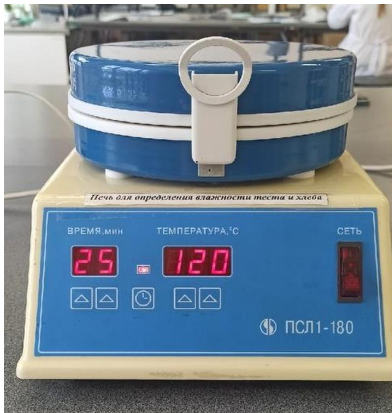
Рисунок Е – Аппарат для измерения влажности
