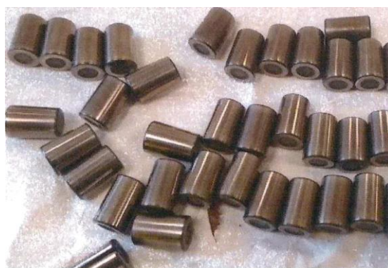
Рисунок 15 – Следы разогрева в виде цветов побежалости на внутренней поверхности обоймы подшипника и роликах
