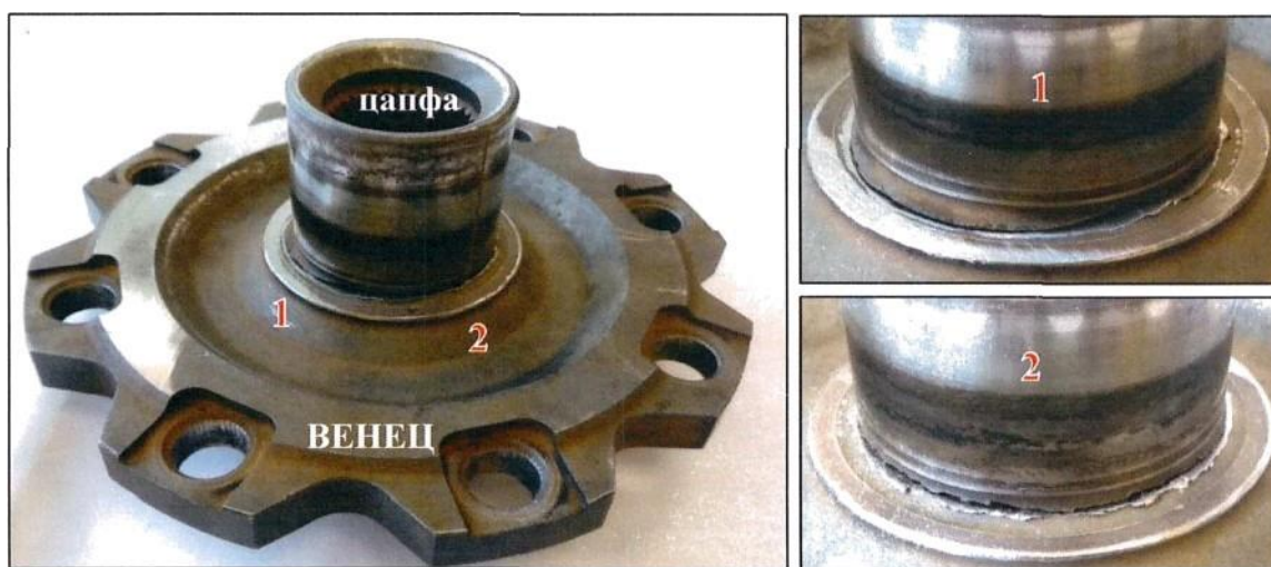
Рисунок 12 – Внешний вид ступицы колеса, место разрушения
