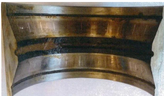
Рисунок 15 – Следы разогрева в виде цветов побежалости на внутренней поверхности обоймы подшипника и роликах
