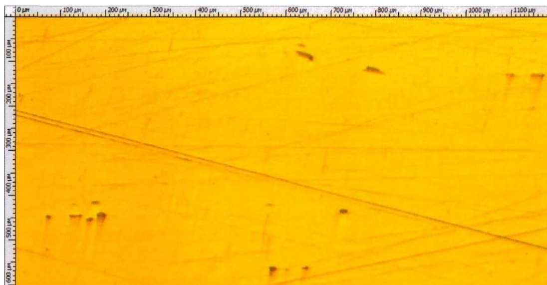
Рисунок 16 – Загрязненность металла неметаллическими включениями, увеличение в 100 раз
