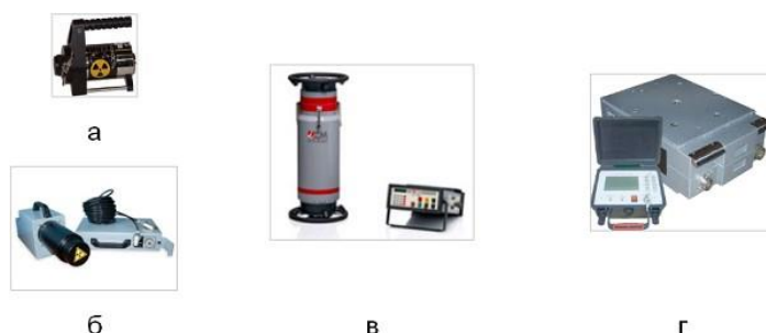
а – гамма-дефектоскоп на основе радионуклида \text{Se-75} РИД-Se4P, б – рентгеновский аппарат импульсного действия Арина-3, в- рентгеновский аппарат непрерывного излучения ICM SITE-X C2004, г – бетатрон
