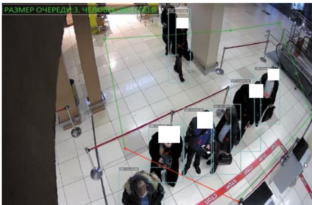
Рисунок 4 – Пример работы модуля IDIS оценки длины очереди и скорости обслуживания
