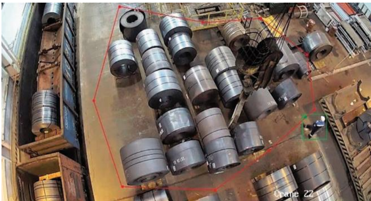
Рисунок 2 – Пример работы модуля контроля Axis Communications нахождения людей в зоне работы крана
