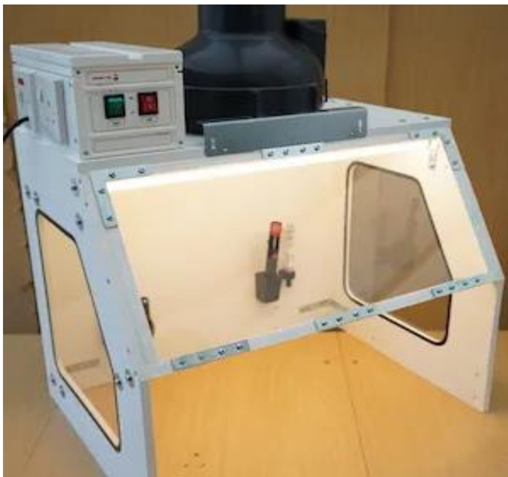
Рисунок 9 – Готовый вытяжной шкаф для пайки
