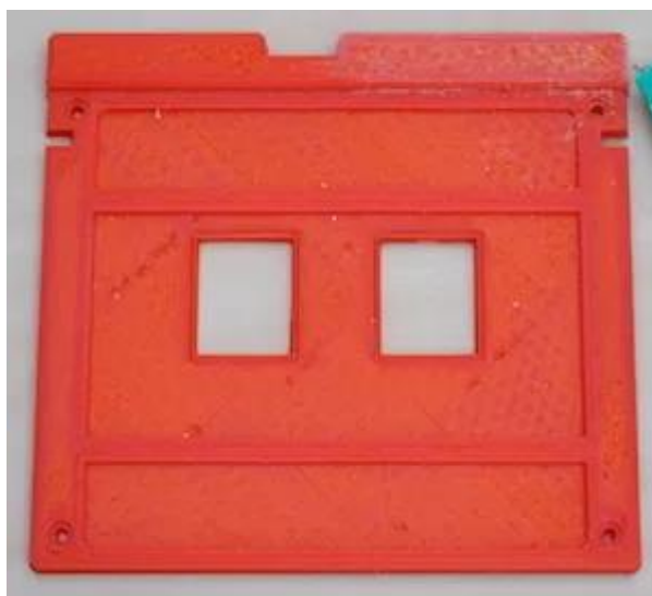
Рисунок 8 – Напечатанная панель кнопок при помощи 3D-печати
